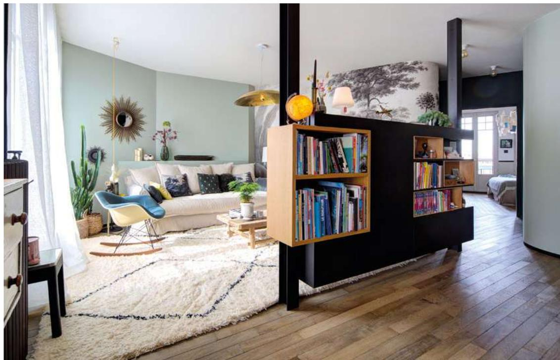
**Meuble TV.** La démolition d'une cloison a fait apparaître un IPN structurel. Seuil Architecture en a installé un second pour fixer entre les deux le meuble TV créé sur-mesure en placage chêne et médium anthracite.
